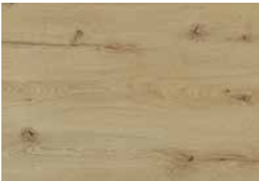
L1 HRAST GRČA PUKOTINA
