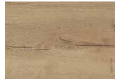
L1 HRAST GRČA PUKOTINA
