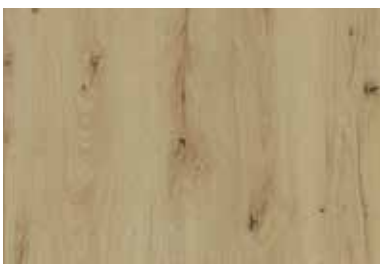
HRAST GRČA PUKOTINA
