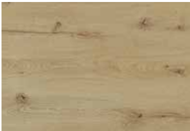
L1 HRAST GRČA PUKOTINA
